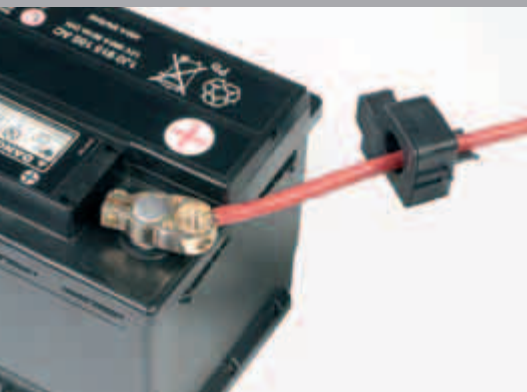
Stromwandler direkt um das Anschlusskabel der Autobatterie montiert
