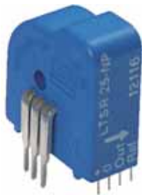
Fig 1. Capteur LTSR pour 6, 15 and 25 A eff nominal.
