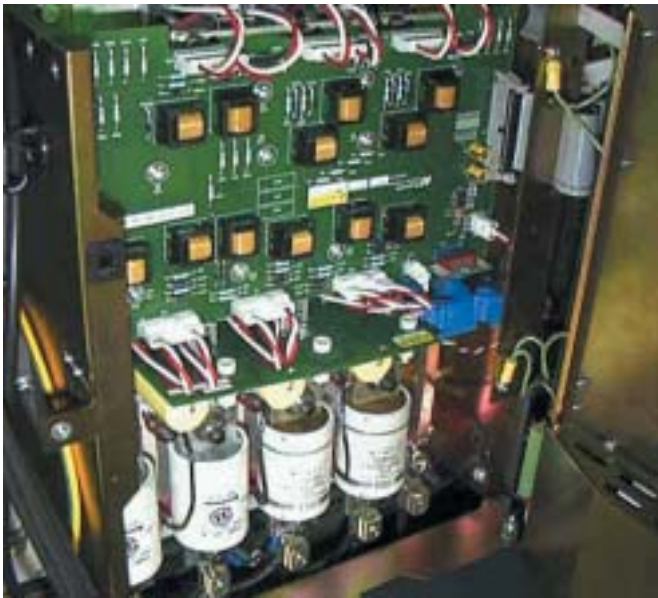
Bild 8: LF 305-S in einem Umrichter für die Aufzugssteuerung.
