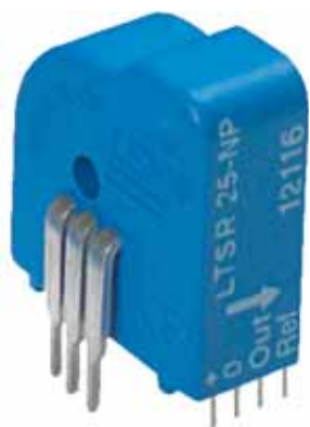
Bild 1: Ein einzigartiger Stromwandler: LTSR
