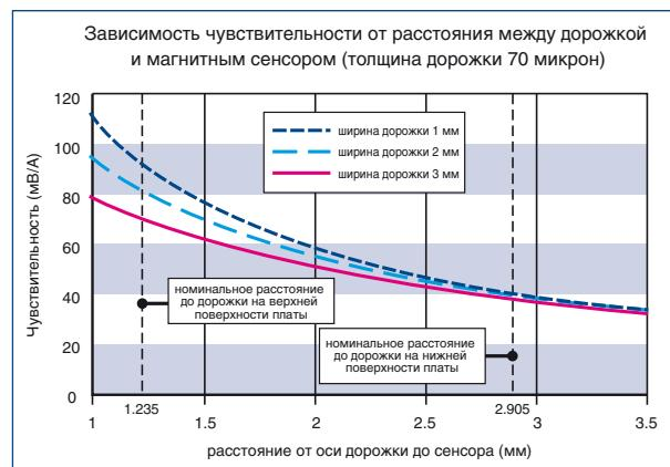
Рис. 3: Чувствительность (mV/A) в зависимости от ширины дорожки и расстояния между ней и чувствительным элементом.
