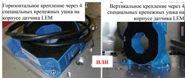
Рис. 2. Способы крепления датчика: горизонтальный ИЛИ вертикальный
