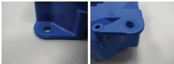
Рис. 4. Повреждение крепежного ушка датчика LEM из-за ненадлежащей конструкции опорного элемента
