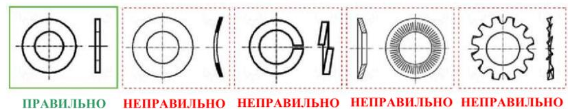
Рис. 9. Рекомендации по выбору шайб для непосредственного крепления датчиков LEM винтами через пластмассовые ушки на корпусе
