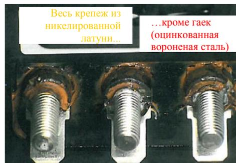
Рис. 14. Коррозия соединений вторичной цепи датчика при неудачном выборе материала гаек
