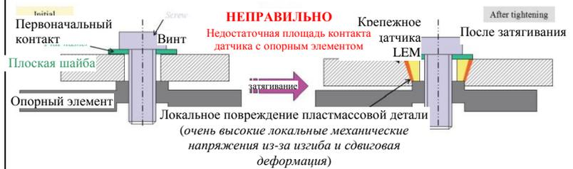
Рис. 6. Недостаточная площадь поверхности контакта с опорным элементом в окрестности головки винта
