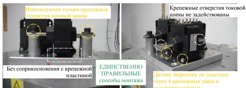
Рис. 1. Крепление датчика к пластине с помощью отверстий в токовой шине или крепежных ушек на корпусе
