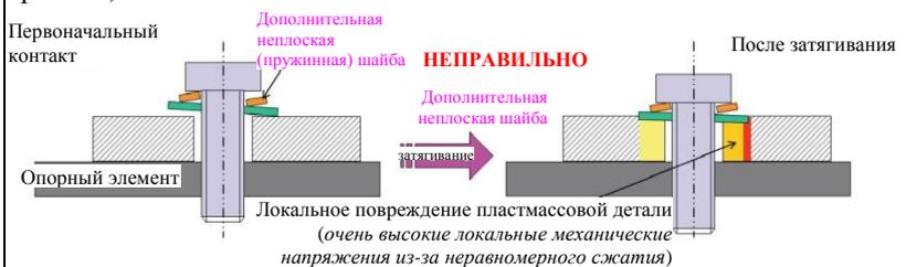
Рис. 11. Риск при креплении с применением пружинных шайб
